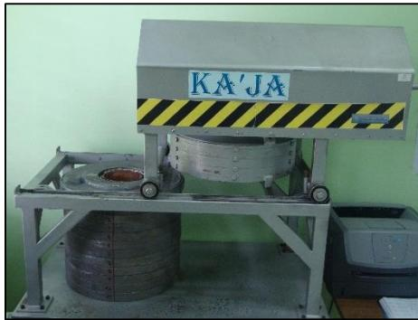
Slika 22: Olovna zaštita koja okružuje detektor i poklopac olovne zaštite
