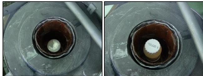
Slika 23: Kapa detektora: sa i bez standardnog izvora zračenja. Vidimo i dodatne obloge od kalaja i bakra sa unutrašnje strane olovne zaštite
