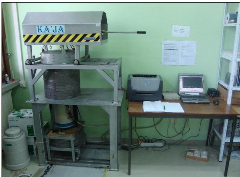
Slika 24: Detektorski sistem korišten u snimanju spektra standardnog uzorka
