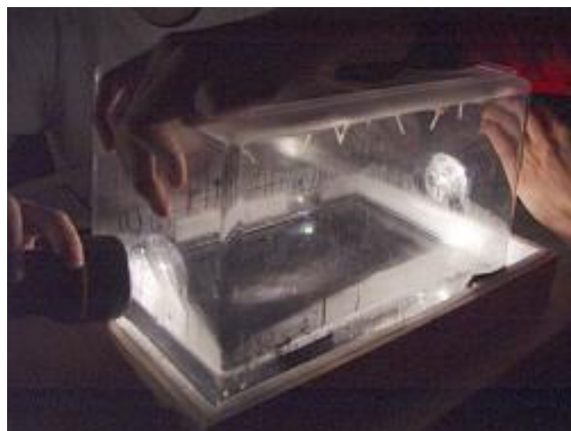
Slika 27. Osvetljavanje maglene komore i posmatranje tragova čestica kosmičkog zračenja
