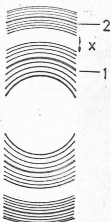
komponente iznosi  $\frac{1}{2} \cdot 0,47 \text{ B}$ . Ako sa  $x$  označimo rastojanje između krajnjih susednih komponenata, od kojih jedna potiče od interferentnog prstena (1), a druga od interferentnog prstena (2), to prema (Sl-III-1) možemo pisati
