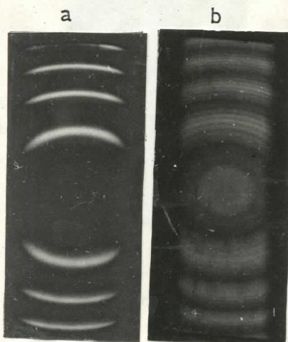
Fot. 1. transverzalni Zemanov efekt zelene linije Hg: a) bez polja b) sa poljem od 0,9 T
