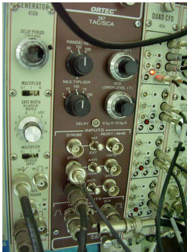
Sl.64. NIM moduli koji predstavljaju deo antikoincidentnog kruga . Sleva na desno: DELAY AND GATE GENERATOR koji je na elektronskoj šemi označen kao D&G(1); TAC/SCA modul; QUAD CFD- četvostruki diskriminator konstantne frakcije u grani plastičnih detektora čije je samo prvo polje iskorišteno
