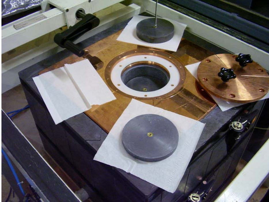
Sl.29. Pasivna zaštita Ge spektrometra u LSM laboratoriji
