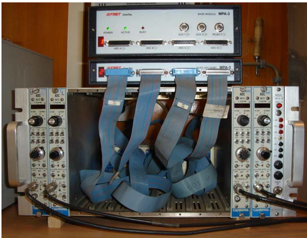
Sl.84. Multiparametarski sistem MPA-3, sa 4 priključena ADC-a.
