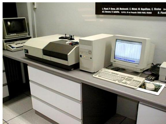
Slika 6.4. Izgled UV/VIS/NIR Perekin-Elmer spektrofotometra, model Lambda-19
