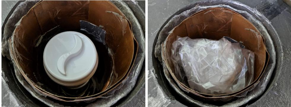
Slika 5.4: Položaj uzorka na aluminijumskoj kapi detektora okruženi olovnom, kalajevom i bakarnom zaštitom
