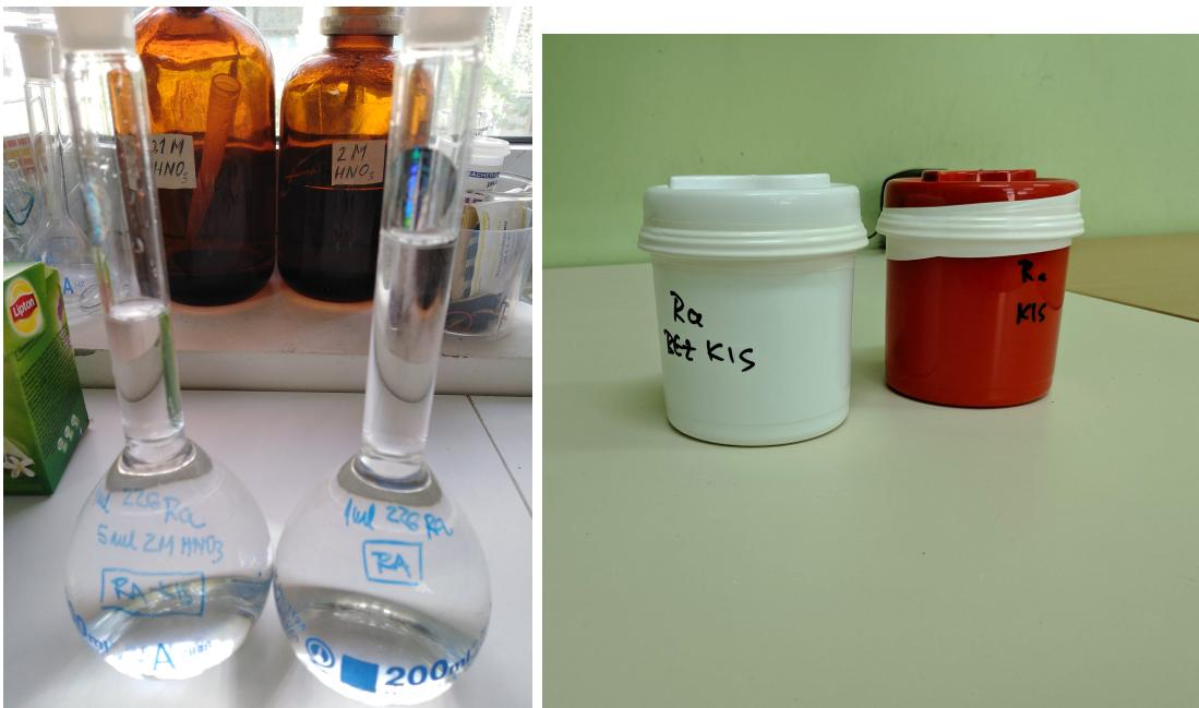
Slika 5.2: Pripremljeni vodeni rastvori  $^{226}\text{Ra}$  i polietilenske bočice spremne za merenje
