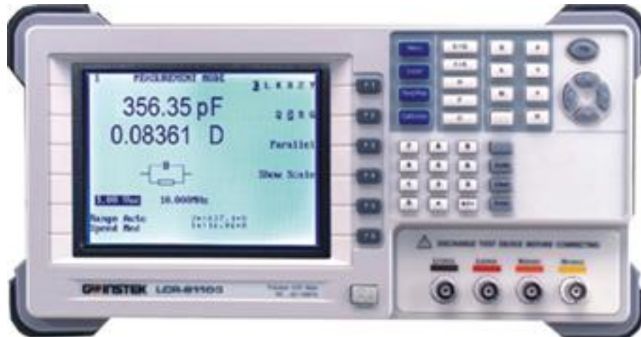
Slika 7.1 Uređaj za merenje električnih osobina uzorka u zavisnosti od frekvencije.
