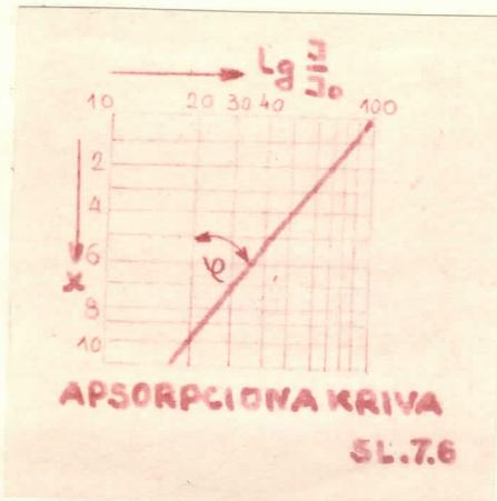
Kod sraćenja sa neprotivnim spektrom zavisnost  $\ln I$  od  $x$  je kriva linija čiji se nagib prema  $x$ -osi sa uvođenjem  $x$  unazad smanjuje, (sl.7.7.-). Koeficijent slabljenja je određena tangentom ugla tangente u svakoj tački krive  $\ln I$  (apsorpcione krive). Počev od
