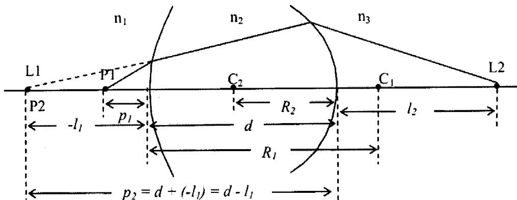
Слика 28. Конструкција лика светле тачке добијеног проласком светlostи кроз дебело сочиво
