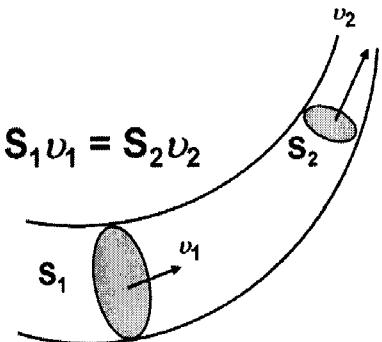
Слика 8. Веза између брзине течности и попречног пресека цеви
