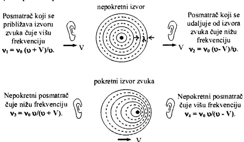
Слика 23. Доплеров ефекат
