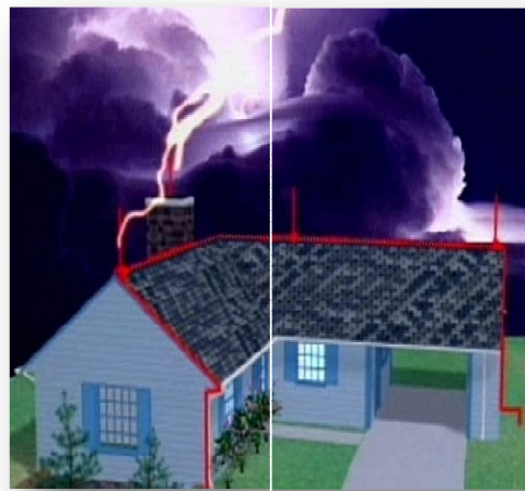
Слика 3. Приказ громобрана на кући
