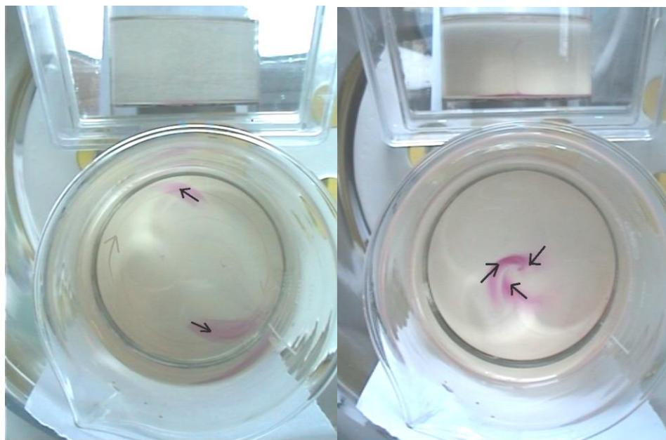
Slika 5.5 Ekmanov tok u rotirajućem (LEVO) i zaustavljenom (DESNO) sistemu.
