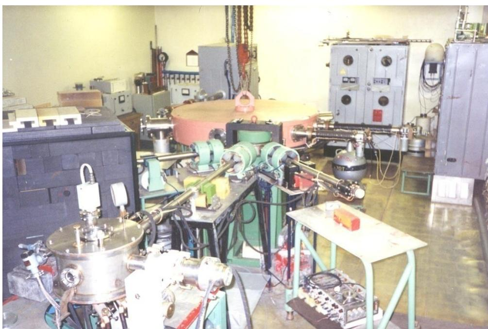
Slika 12 Prikaz mikrotrona korišćenog u eksperimentu
