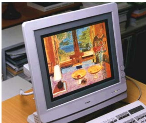
Slika 5.12: Kolor SSFLC displej firme Kenon (Canon) FLCD 15C01 (1995 god.). Karakteristike: rezolucija 1280x1024 (SXGA). Dijagonala 14.8" (38cm), kontrast 40:1, osvetljenost 80cd/m 2 , 4 sub-piksela (crvena, zelena, plava, bela), brzina odziva po liniji 80μs (na sobnoj temperaturi), ćelija 1.1μm.
