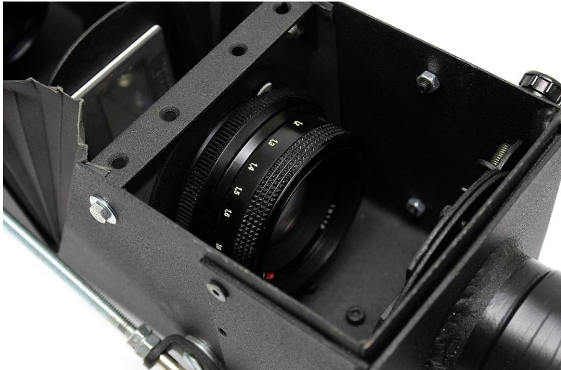
Slika 45. Pogrešno orijentisan objektiv od kolimatora
