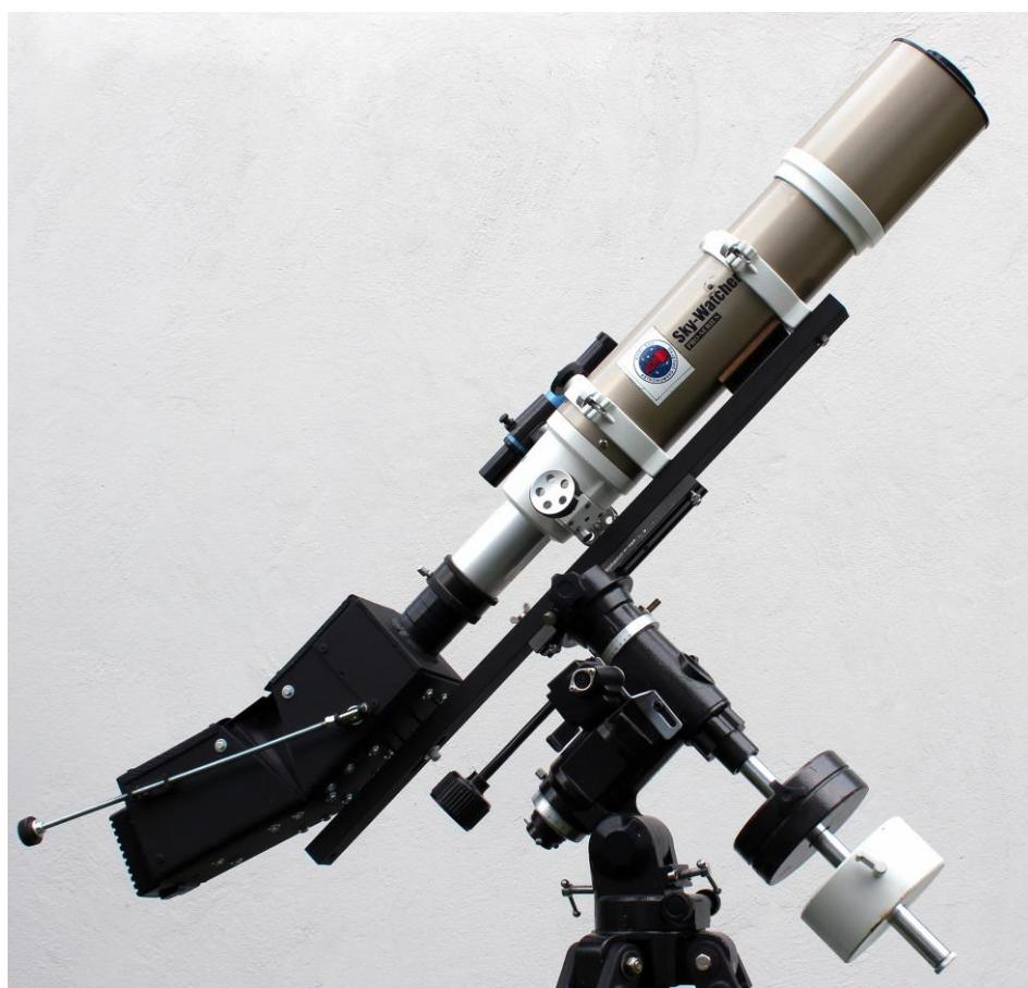
Slika 73. Montirani spektrograf na Skywatcher AP 80/600 ED OTA teleskopu
