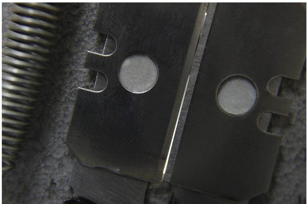
Slika 11. Noževi na spektrografu, otvoreni otprilike 0.3mm
