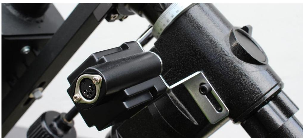
Slika 52. Jedini motor za praćenje na rektascenziji
