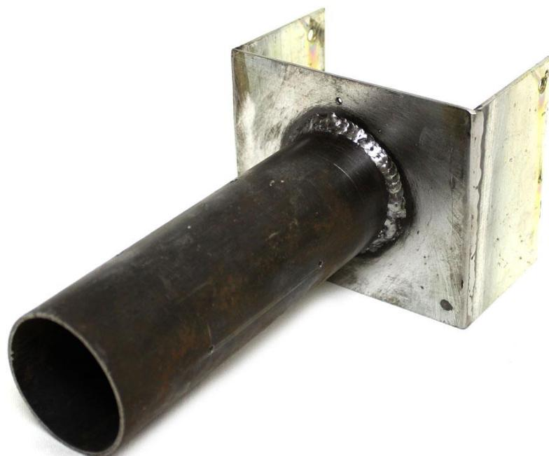
Slika 24. Nosač kućišta spektrograфа koji ulazi u fokuser teleskopa
