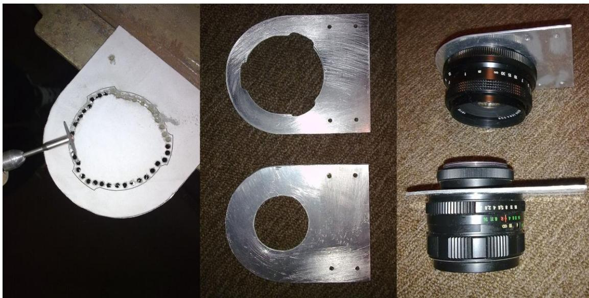
*Slika 22. Izrada nosača za objektive kolimatora i kamere*
