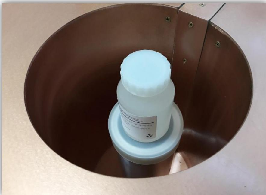
Slika 8. Eksperimentalna postavka detektora sa odgovarajućim referentnim materijalom
