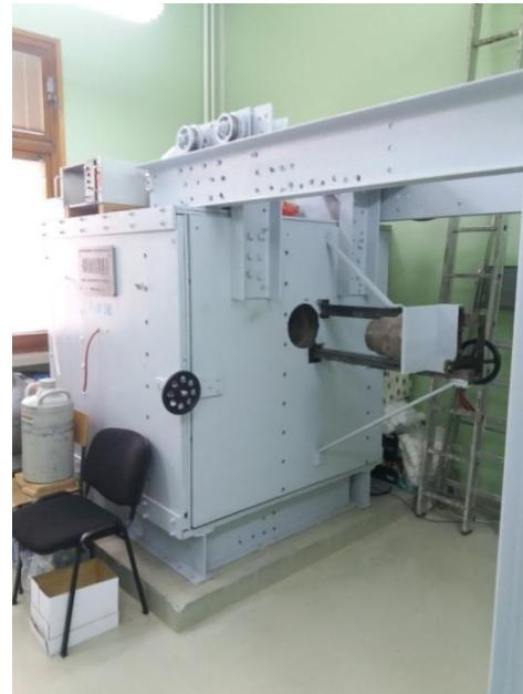
slika 25 – HPGe detektor proizvođača CANBERRA i njegova Fe zaštita
