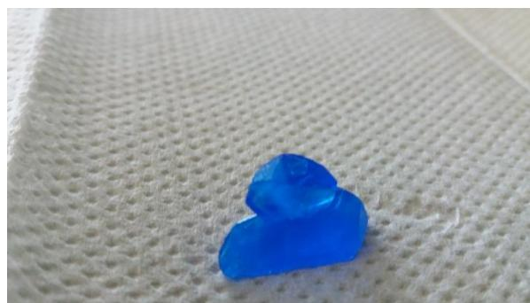
*Slika 5.8: Uzorak na kom je realizovano eksperimentalno određivanje indeksa prelamanja kristalnim refraktometrom*
