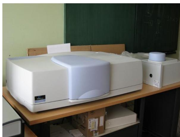
*Slika 5.11:* UV/VIS/NIR spektrofotometar korporacije Perkin-Elmer model Lambda-950, sa dvostrukim snopom
