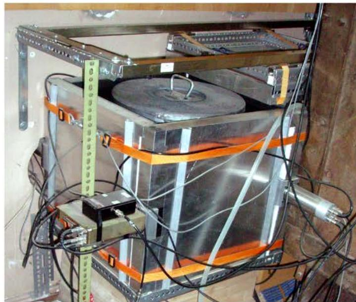
**Slika 5.2 – Fotografija HP Ge detektor u laboratoriji sa olovnom zaštitom i vetro scintilacionim detektorima oko njega**
