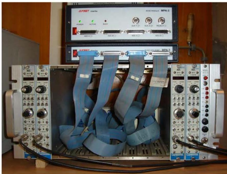
Slika 5.6 – Fotografija baznog modula MPA-3 sistema
