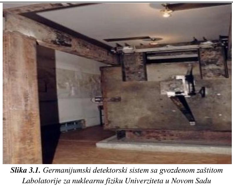
*Slika 3.1. Germanijumski detektorski sistem sa gvozdenom zaštitom
