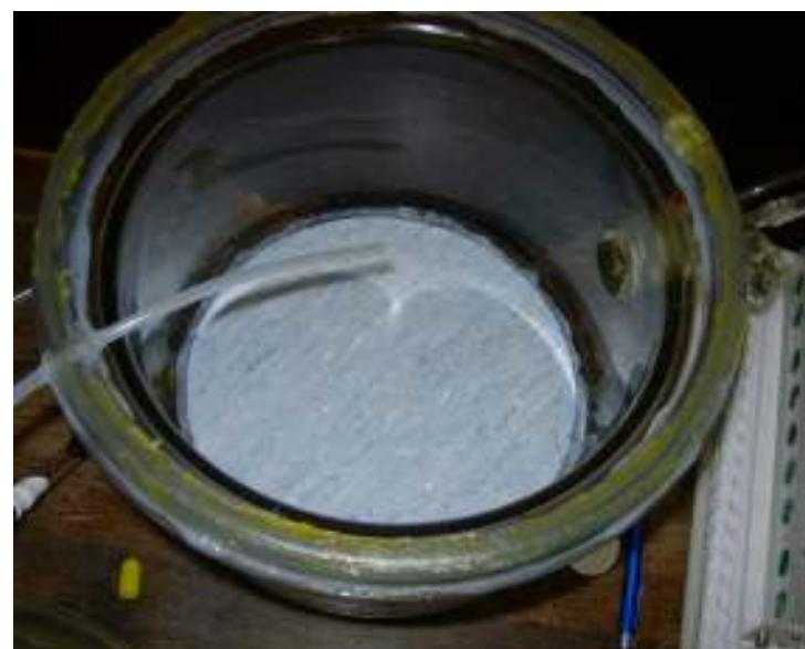
Slika 20. Izgled eksikatorske posude pre zatvaranja. Na slici je postavljen tarkett linoleum-prvi uzorak koji se meri (svetlo plava površina). Takođe se jasno vide površine silikonske paste
