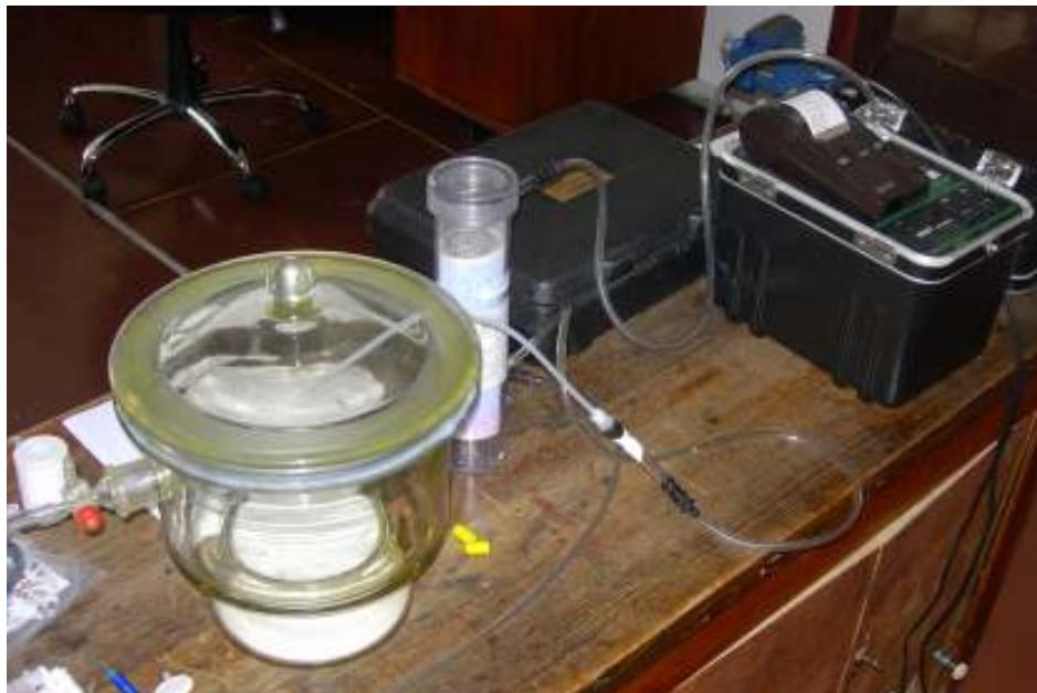
Slika 22. Na slici je prikazana postavka za eksperiment za merenje koncentracije radona u slučaju kada nije postavljen uzorak.
