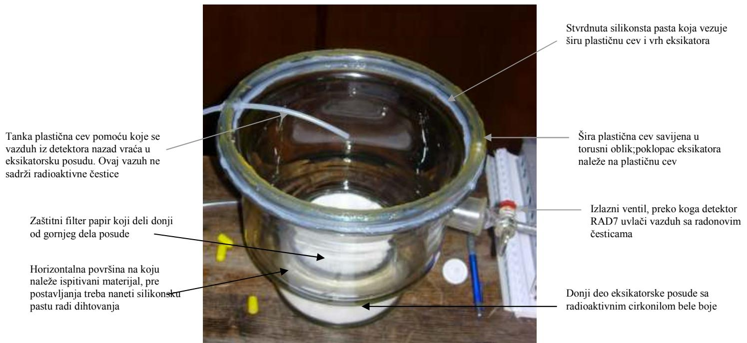
Slika 18. Fotografija eksikatorske posude sa postavljenim zaštitnim filter papirom, bez ispitivanog uzorka i postavljenim plastičnom cevčicom za vraćanje vazduha u eksikatorsku posudu.
