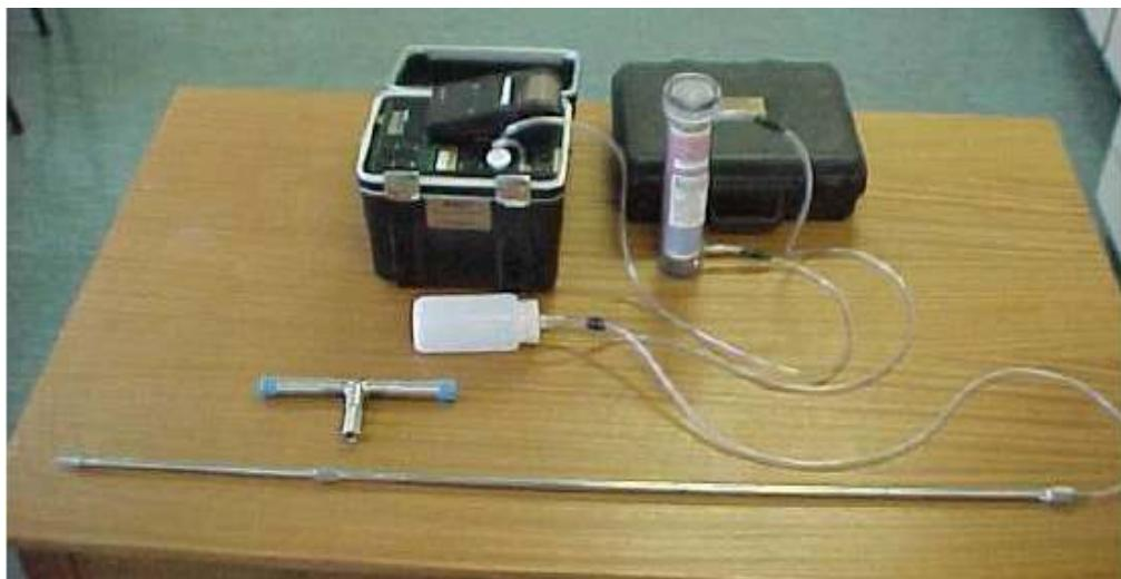
Slika 15. Klasična postavka uređaja RAD7 sa pratećim uređajima
