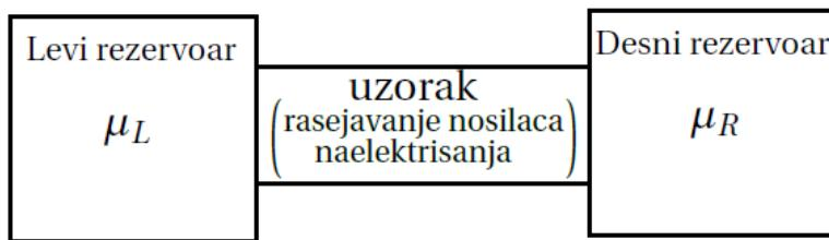
Slika F.1:Šematski prikaz sistema koji se sastoji od dva rezervoara i uzorka u kojem se vrši rasejavanje nosilaca nanelektrisanja.
