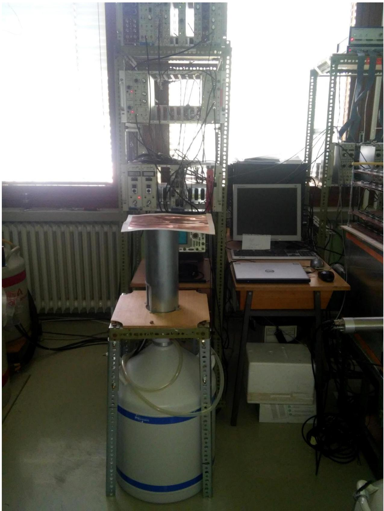
Slika 24, Planarni HPGe detektor
