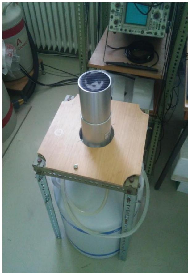
Slika 23, Planarni HPGe detektor
