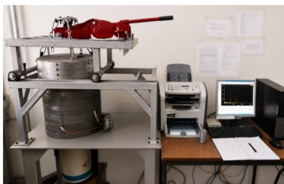
Slika 6.9. HPGe detektorski sistem CANBERRA GC–3518
