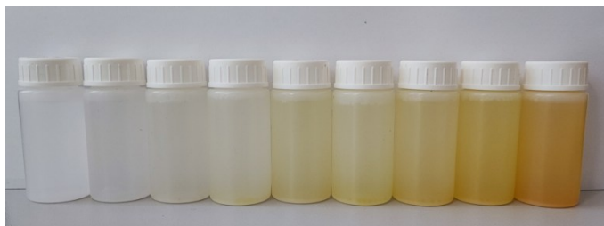
Slika 7.6. Serija quench test uzoraka pripremljenih sa Mineral Oil scintilacionim koktelom za određivanje SQP-kalibracione krive.
