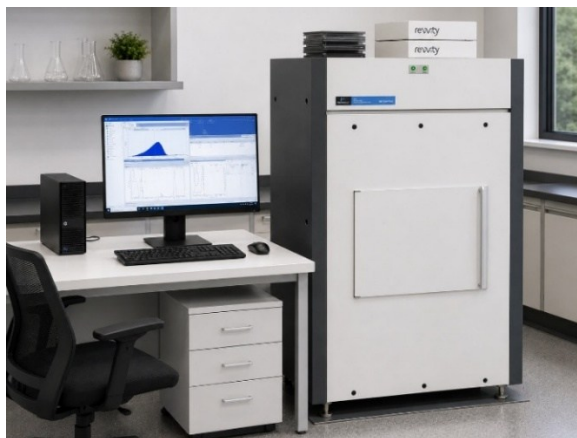
Slika 4.13. Niskofonski tečni scintilacioni spektrometar Quantulus 1220 TM
