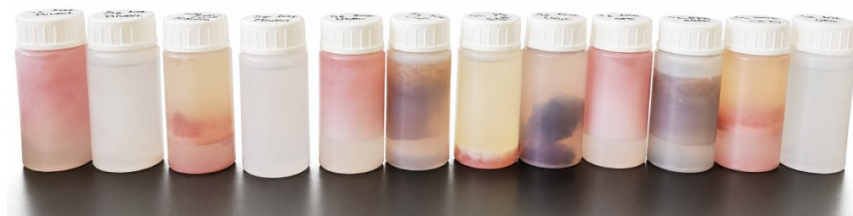
Slika 7.12. Vizuelne promene u pripremljenim uzorcima industrijskih otpadnih voda nakon stajanja, sa pojavom zamućenja i taloga u pojedinim mernim bočicama.
