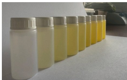
Slika 7.8. Serija quench test uzoraka pripremljenih sa Opti-Fluor O scintilacionim koktelom za određivanje SQP-kalibracione krive.
