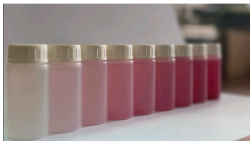
Slika 7.10. Serija quench test uzoraka pripremljenih sa Ultima Gold F scintilacionim koktelom za određivanje SQP-kalibracione krive.
