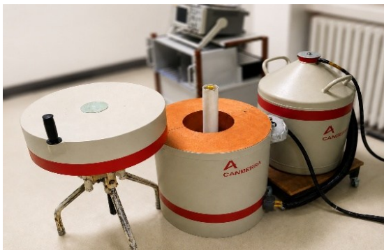
Slika 6.11. B HPGe detektor Canberra GX10021 sa pasivnom zaštitom.
