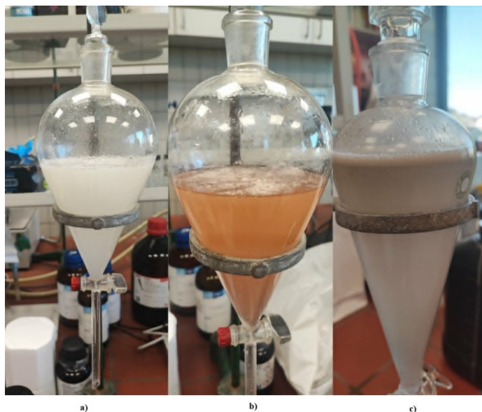
Slika 6.8. Priprema uzoraka industrijskih voda u separacionim levcima tokom ekstrakcione faze LSC metode: a) uzorak otpadne vode iz preduzeća „Voćar-Promet”, Zvornik; b) uzorak iz industrijskog kompleksa „Alumina”, Zvornik; c) uzorak vode iz Termoelektrane Stanari
