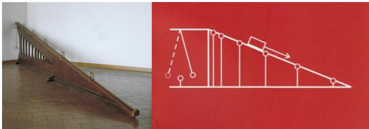
**Slika 2.1.** Galilejev eksperiment – osnovne kinematičke zakonitosti kretanja tela sa konstantnim ubrzanjem
