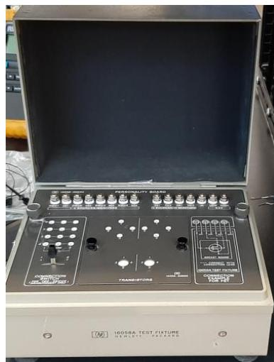
Slika 10. Jedinica za testiranje uzoraka 16058 A.
