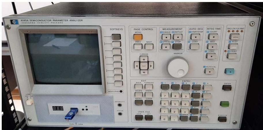
Slika 9. Analizator poluprovodničkih parametara Hewlett-Packard 4145 A.
