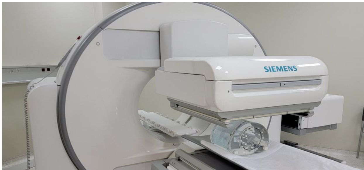
Slika 26. Skeniranje NEMA fantoma na SPECT/CT-u
