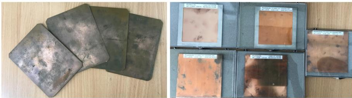
Slika 7.3 Set starih (levo) i novih apsorbera od bakra (desno)
