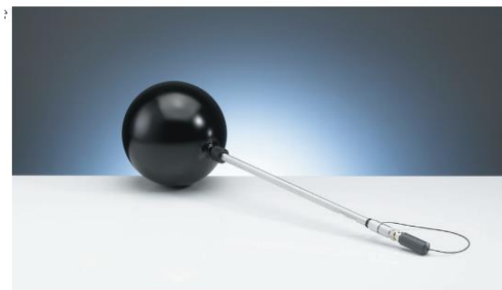
Slika 4.3 Sferna jonizaciona komora proizvođača PTW tip 32002
