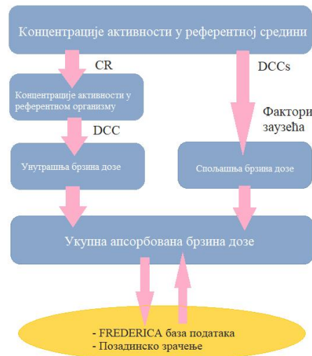
Слика 18. Одређивање укупне брзине апсорбоване дозе [Brown, Beresford and Hosseini, 2012]
