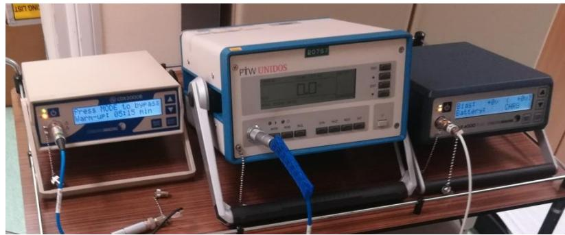
Slika 10: Korišćeni elektrometri; sleva na desno: Standard Imaging CDX200B, PTW Unidos i Standard Imaging MAX4000+
