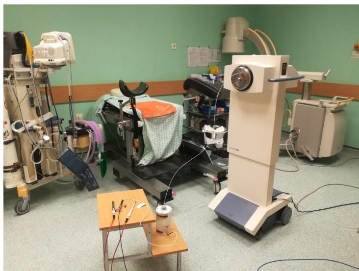
Slika 2: Postavka aparature za kalibraciju izvora
