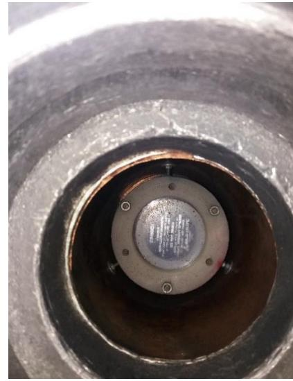
Slika 4.2. Otvor HPGe detektora GMX-20190 – na kapu detektora se postavlja uzorak.
