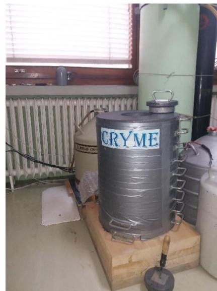
Slika 4.1. HPGe detektor GMX-20190 u olovnom štitu.
