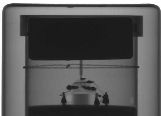
**SLIKA V.15:** Radiografski snimak LEGe detektora (model GL2020) koji u velikom detalju ilustruje unutrašnju strukturu ove detekcione opreme.
