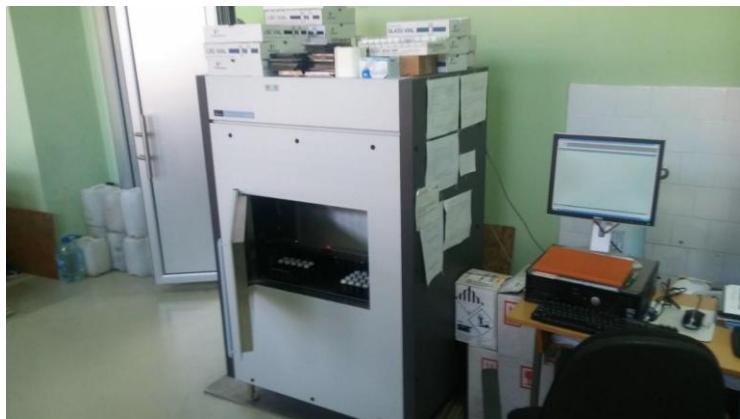
Slika 2.8. Tečni scintilacioni spektrometar Quantulus 1220<sup>TM</sup>
