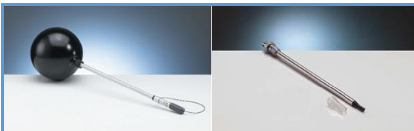
Slika 12. Na lijevoj strani sferna jonizaciona komora proizvođača PTW tip TM 32002 zapemine 10^3\text{ cm}^3 , a na desnoj cilindrična komora proizvođača PTW tip TM 23331 zapemine 1\text{ cm}^3 . [5]
