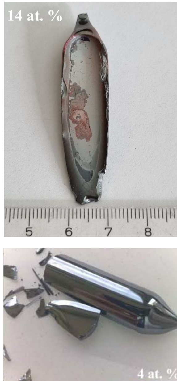
Slika 3. Izgled sintetisanog uzorka \text{Ag}_{14}(\text{As}_{40}\text{S}_{30}\text{Se}_{30})_{86} i primer stakla sa x = 4 at. % Ag iz istog sistema [5].
