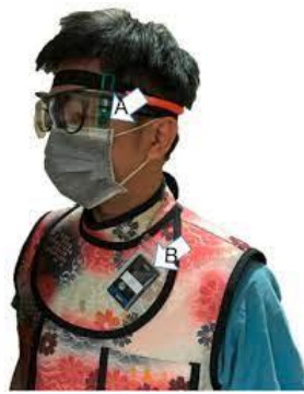
Slika 21. Demonstracija lokacije dozimetara u kliničkim merenjima (interventna radiologija): A) H_p(3) dozimetar na viziru i B) dozimetri preko okovratnika, H_p(0,07) i H_p(10) .
