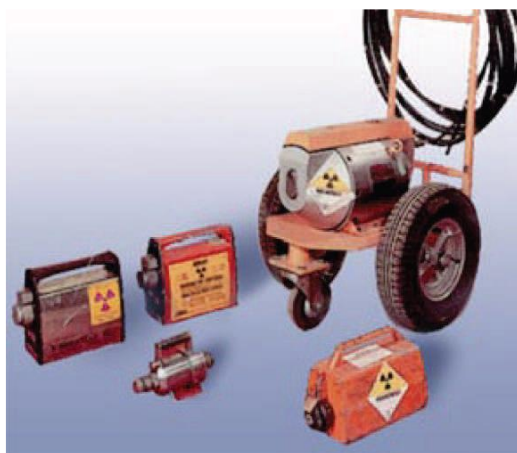
Slika 3. Prenosivi i mobilni kontejneri sa radioaktivnim izvorima [3]
