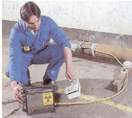
Slika 10. Radnik proverava da li je radioaktivni izvor bezbedan [3]
