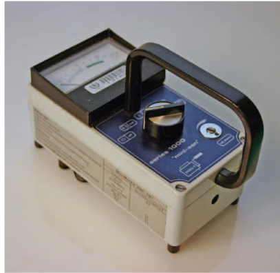
Slika 8. Dozimetar za merenje ambijentalnog ekvivalenta doze [3]
