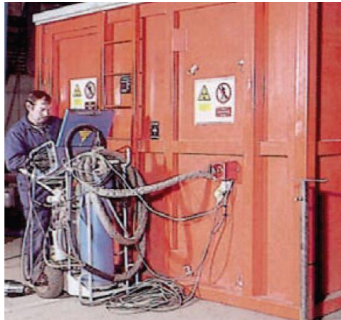
Slika 6. Radnik upravlja radiografom smeštenim u radiografsko kućište [3]
