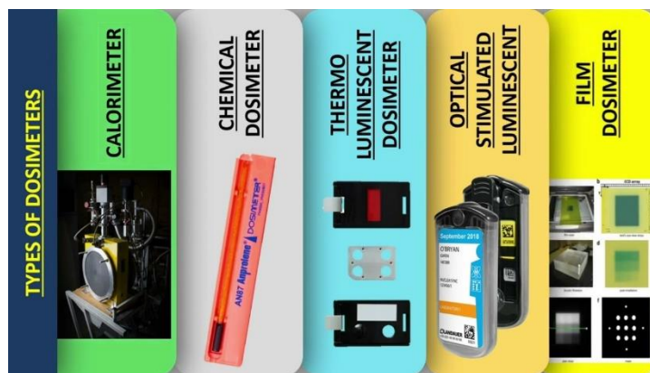
Slika 12. Kalorimetar, hemijski dozimetar, termoluminiscentni dozimetar, optički stimulisani luminescentni dozimetar i filmski dozimetar
