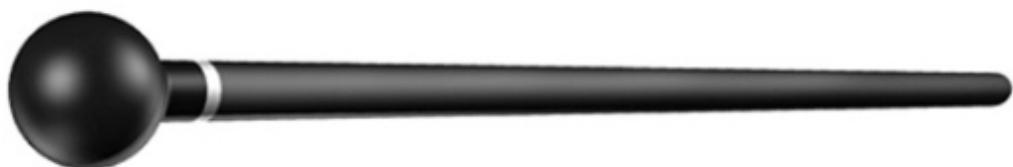
Slika 17. Ionizaciona komora Exradin A3
