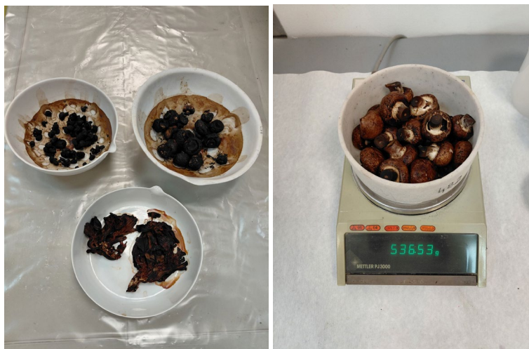
Slika 5.5 a) Uzorci nakon sušenja na 105 °C; b) Merenje mase suvih uzoraka.
