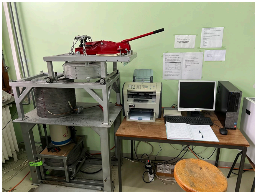
Slika 5.1 HPGe detektor (GMX-20190).
