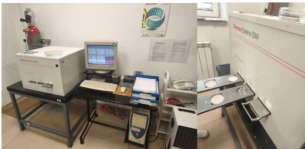
Slika 5.7 a) Niskofonski gasni proporcionalni brojač Thermo Eberline FHT 770T; b) Izgled i raspored planšeta.
