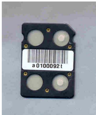
Слика М2: Носач са два ТЛ детектора. Приликом очитавња овај носач се вади из кућишта дозиметра и поставља у читач.
