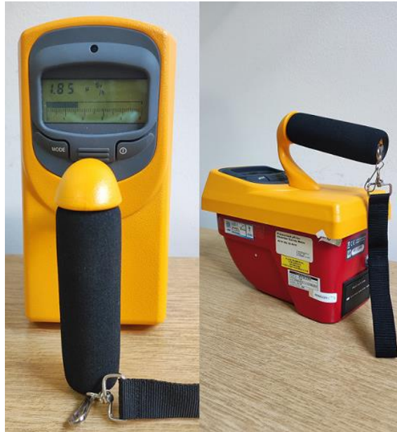
Слика 10: Јонизациона комора (произвођач: Fluke Biomedical, модел: 451P) која се користи као амбијентални монитор зрачења.
