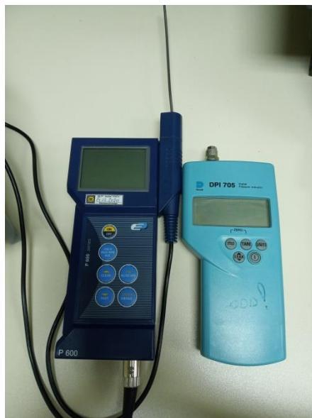
Slika 15. Termometar i manometar
