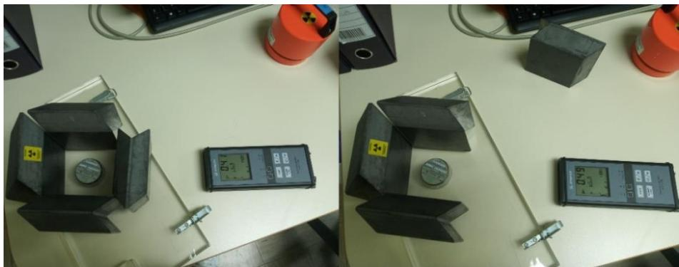
Slika 18. Eksperimentalna postavka za proveru uticaja fona na merenje sa uređajem za planparalelne komore
