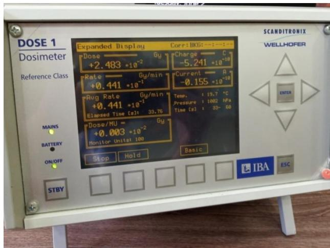
Slika 9. Elektrometar koji je korišćen u eksperimentu
