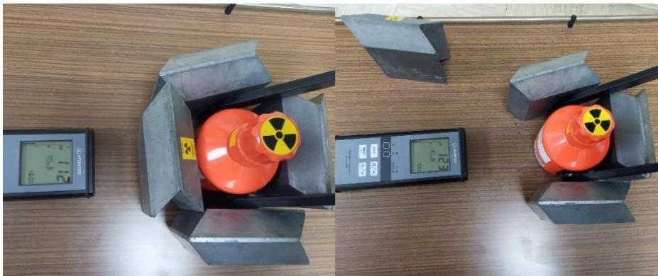
Slika 17. Eksperimentalna postavka za proveru uticaja fona na merenje sa uređajem za cilindrične komore
