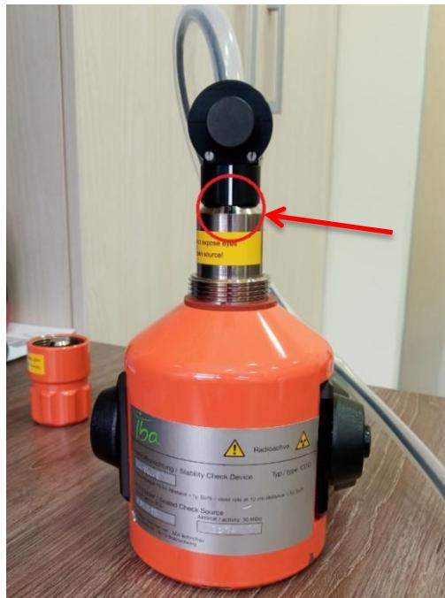
Slika 12. Postavka cilindrične ionizacione komore sa adapterom u odgovarajući uređaj; poklapanjem crnog zareza na RCD-u i belog zareza na adapteru omogućeno je fiksiranje ionizacione komore u uređaju.
