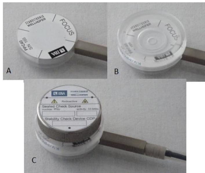
Slika 14. Planparalelna komora bez (A) i sa adapterom (B) kao i sa izvorom [5]
