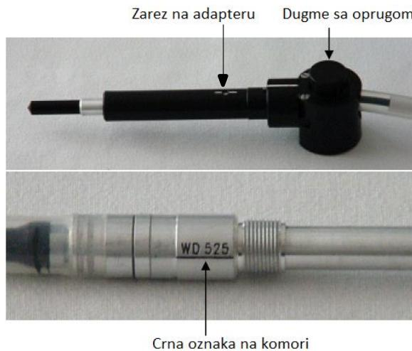
Slika 11. Izgled adaptera za farmer tip ionizacione komore (slika gore) i oznaka na ionizacionoj komori (slika dole) [5].
