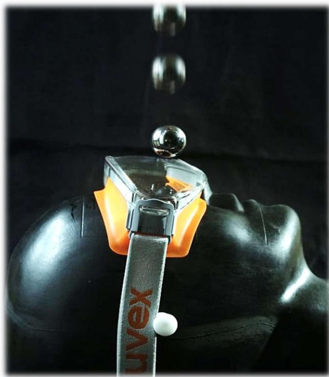
*Slika 23:* Test ispuštanja kuglice<sup>[31]</sup>
