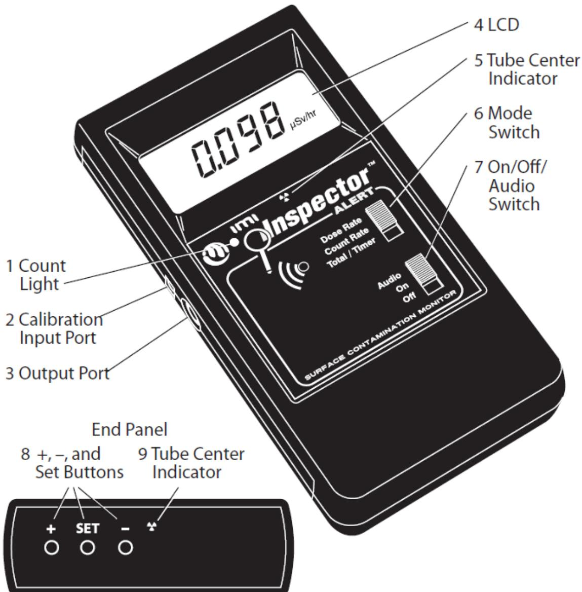
Slika 26. Izgled Inspector Alert detektora sa označenim komponentama.
