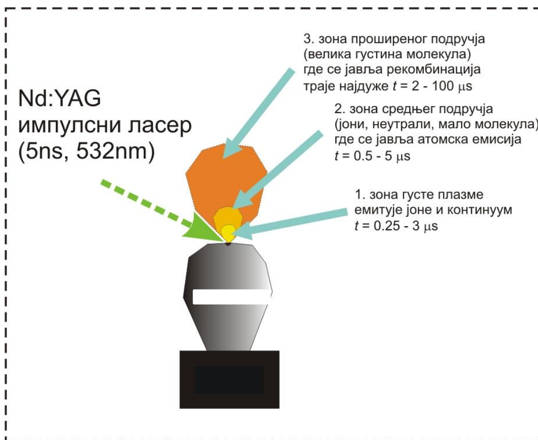
Слика 15. Шематски приказ ласерске аблације и формирања индуковане плазме
