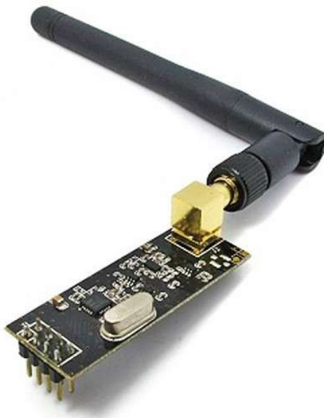
Slika 7.5 Visokofrekventni nRF24L01+ modul sa ugrađenom eksternom antenom i SMA konektorom za prošireni domet]
