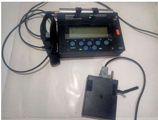
Slika 7.24 Povezivanje predajnika 4 na 9-pinski RS232 serijski port Rainbow MCA 7010 analizatora
