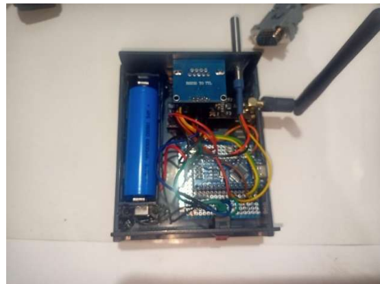
Slika 7.24 Povezivanje predajnika 4 na 9-pinski RS232 serijski port Rainbow MCA 7010 analizatora
