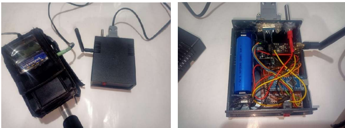
Slika 7.23 Povezivanje instrumenta Inspector EXP preko optokaplenskog modula na Arduino Nano predajnik
