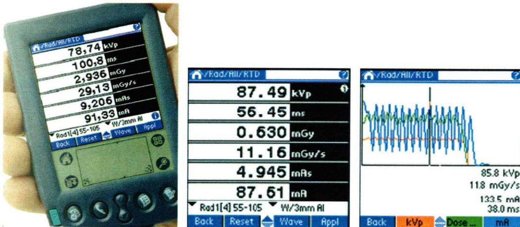
Slika 26. Barracuda detektor za kontrolu kvaliteta snopa X-zraka
