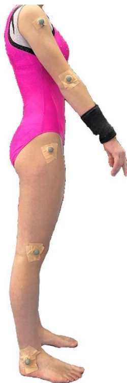
Slika 29. Markeri na mestima antropometrijskih tačaka: skočni zglob, koleno, kuk, rame i lakat
