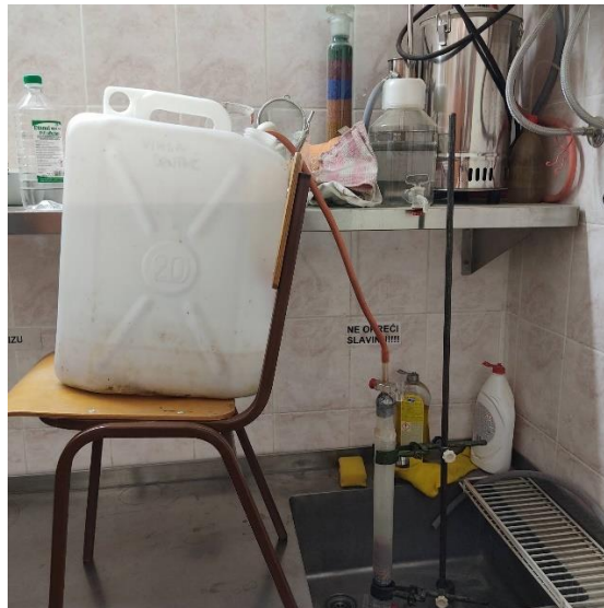
Slika 4.2 Prikaz postupka propuštanja zakišeljene vode kroz jonoizmenjivačku kolonu
