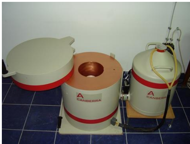
Slika 3.1 Gama-spektrometarski sistem korišten za merenja
