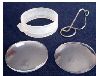
Delovi korišćeni za livenje sočiva prikazuju elastičnu zaptivku, opružnu štipaljku i gornji i donji deo staklenog kalupa.
